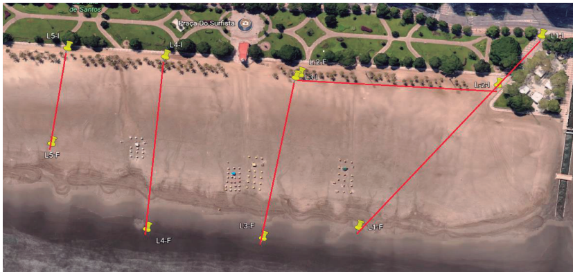
Figura 4 - Linhas de aquisição de georadar. Uma linha paralela a linha do mar (L2) e as outras demais (L1, L3, L4 e L5) em direção ao mar.
