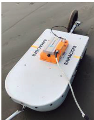
Figura 2 - Equipamento de GPR utilizado na aquisição de dados - RAMAC/GPR (propriedade do IPT/USP).
