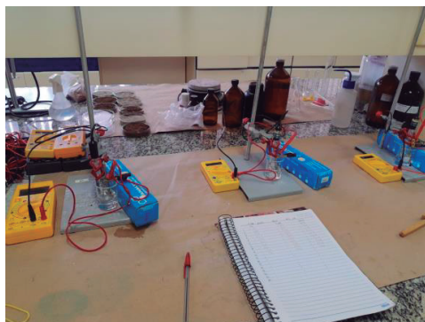
Imagem 1 – Sistema de medição de corrosão.
