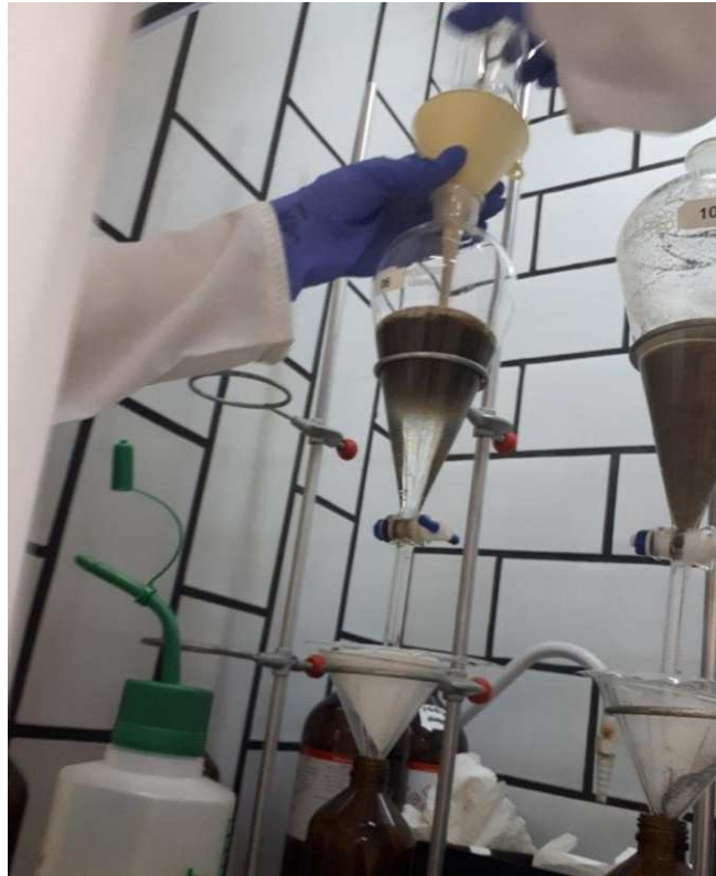
Figura 11 – Amostra de areia sendo inserida no sistema de separação.
