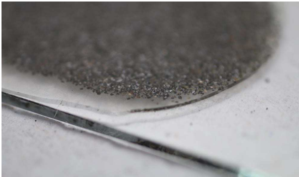
Figura 16 – Exemplo de lâmina de grãos de pesados em montagem. Notar o lixamento da resina e a presença de grãos com face livre (tangenciais à superfície desbastada).
