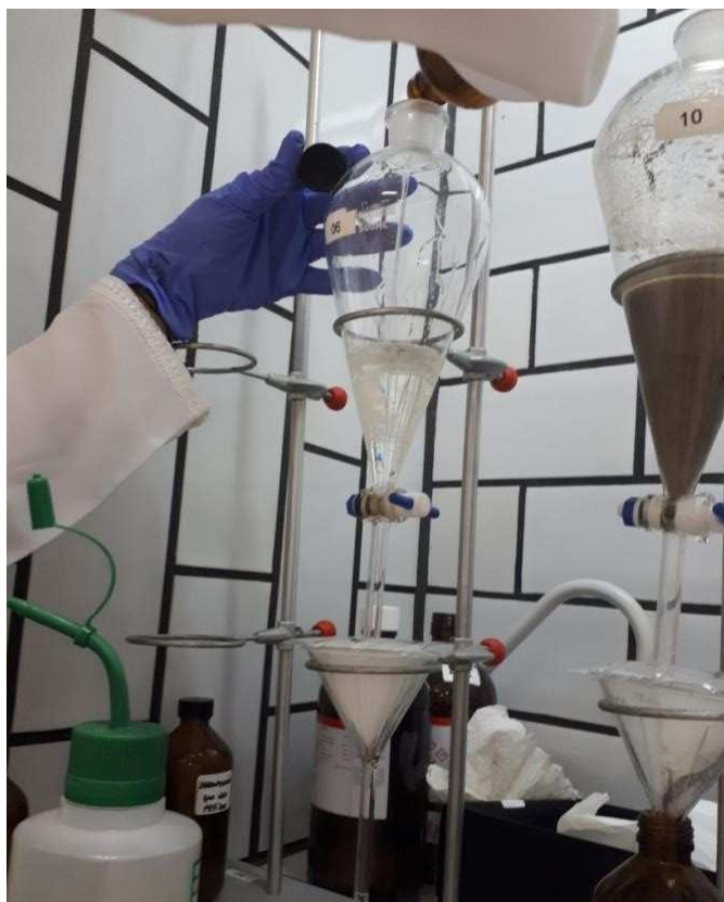
Figura 10 – Bromofórmio sendo vertido no balão de separação.
