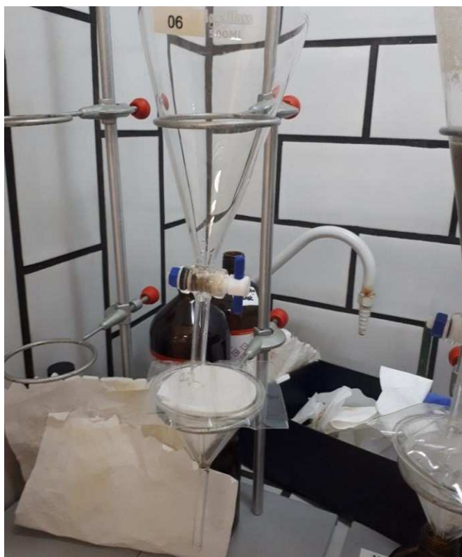
Figura 9 – Sistema de sedimentação sendo preparado.
