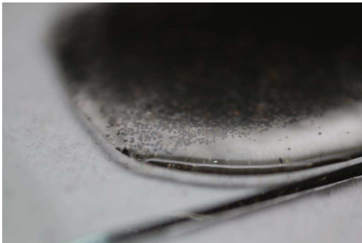
Figura 15 – Exemplo de lâmina de grãos de pesados em montagem. Notar a espessura da resina e os grãos imersos, comparativamente à próxima figura.
