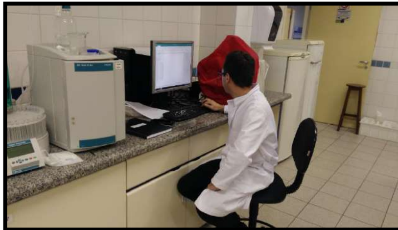
FIGURA 10: ANÁLISE DE ÂNIONS NAS AMOSTRAS DE ÁGUA COLETADAS NOS CANAIS DE SANTOS EM CROMATÓGRAFO IÔNICO 883 BASIC IC PLUS COM AMOSTRADOR AUTOMÁTICO, METROHM
