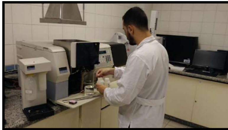
FIGURA 9: ANÁLISE EM EQUIPAMENTO ESPECTROFOTÔMETRO DE ABSORÇÃO ATÔMICA AAANALYST 100 , PERKIN ELMER.
