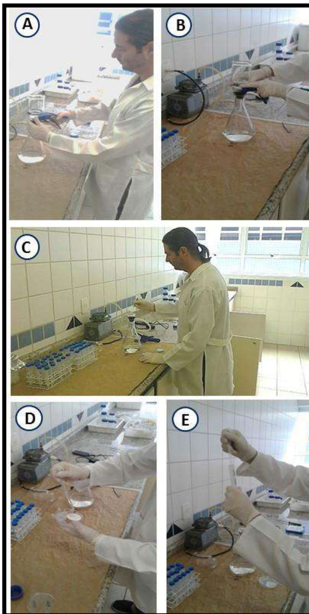
FIGURA 13: PROCESSO DE FILTRAÇÃO À VÁCUO EM MEMBRANAS MILLIPORE PARA CONCENTRAÇÃO DAS AMOSTRAS DE ÁGUA DOS CANAIS.
