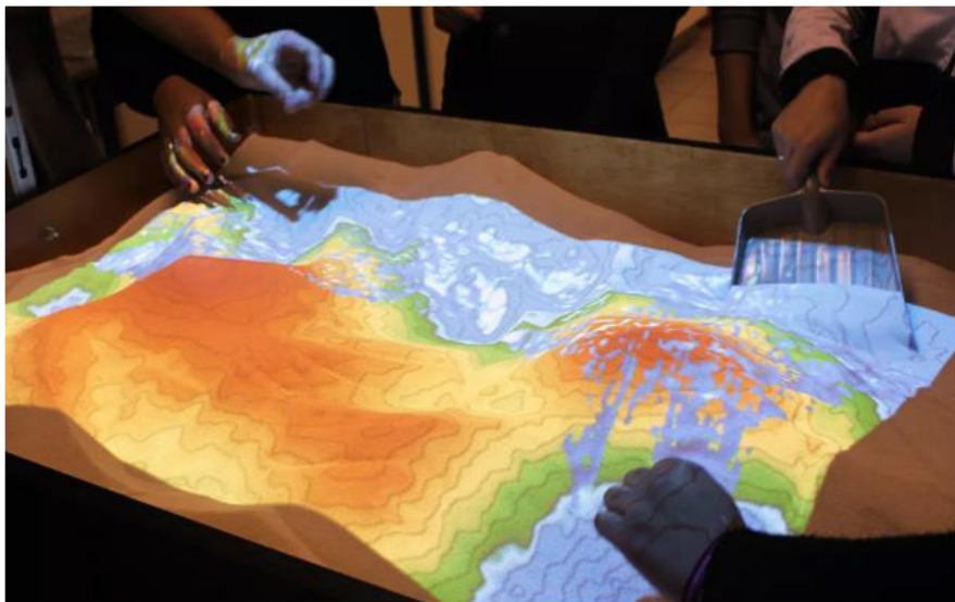
Aparelho SARND BOX, um simulador de relevo, desenvolvido pela Universidade da Califórnia — Foto: Imprensa UniSantos
